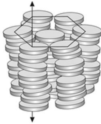
Figure 1-13 : Phase discotique (d'après Kouwer et al. , 2003) formée par des molécules planes. Les colonnes forment ici un réseau hexagonal.
