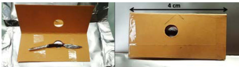
Figure B. 4 – Photographie du porte-échantillon réalisé pour les analyses élémentaires par XRF et PIXE.
