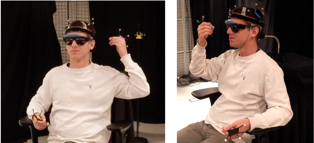
FIGURE 4.3 – Photos d’un sujet réalisant la tâche de pointage proximale. Le sujet porte un objet de pointage dans chaque main avec le marqueur de référence tenu au bout des doigts. La tête est supportée par un appui-tête (c.f figure de droite) pour éviter les mouvements de la tête, et est repérée en temps réel par un système de suivi de position, de même que les objets de pointage. Le sujet utilise la main de son choix pour pointer en laissant l’autre au repos (bras posé sur l’accoudoir).
