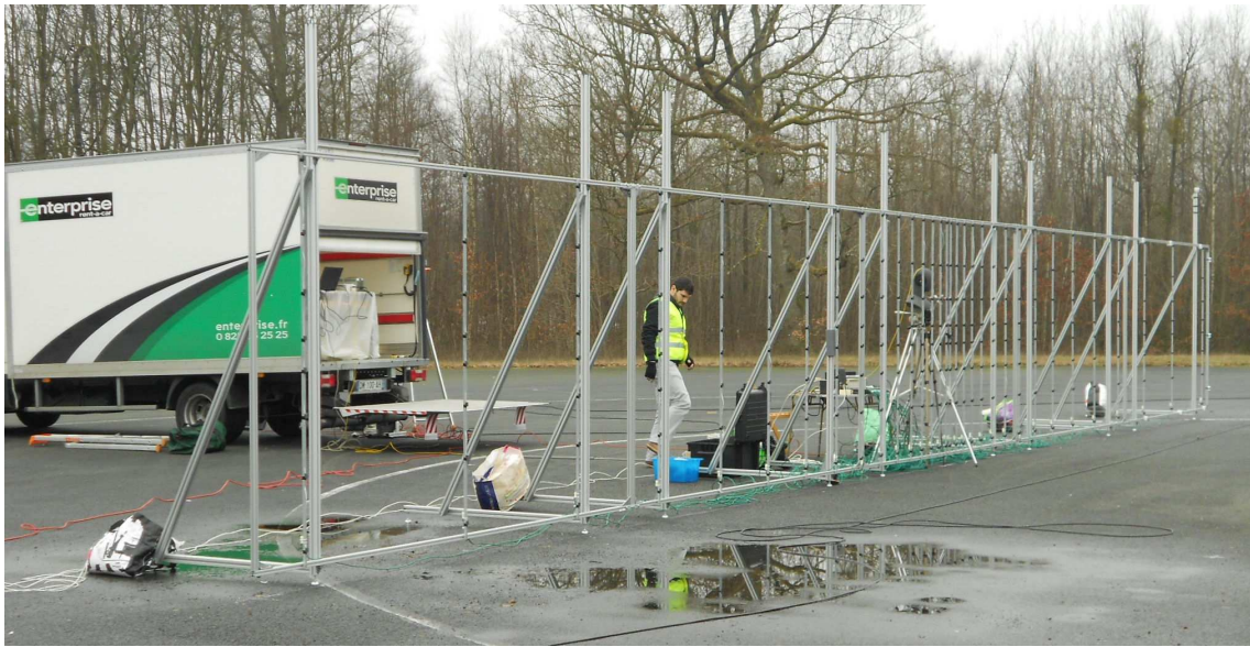
(a) L'antenne de 256 microphones sur le circuit.
