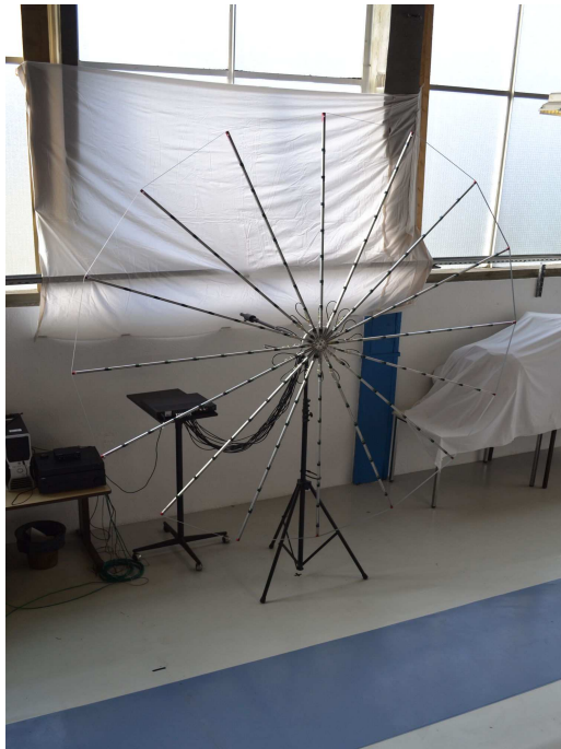
(a) Soleil : réseau circulaire.
