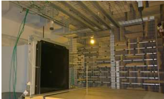
(d) Étude du bruit d'écoulement en soufflerie anéchoïque [92].
