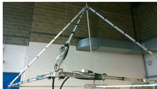
(c) Pyramide : l'assemblage est constitué de pièces fraisées en atelier. La précision du montage est supposé millimétrique.
