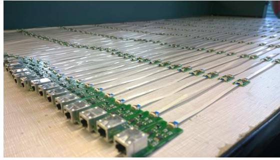
(b) Lignes de huit microphones MEMS : la connectique transmet uniquement des signaux numériques (horloge d'échantillonnage et signaux acoustiques multiplexés) par des câbles RJ-45.
