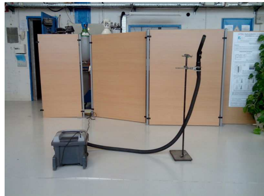
(b) L'aspirateur est placé 4 m devant l'antenne.
