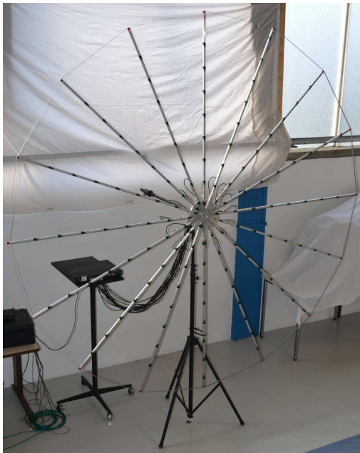
(a) L'antenne Soleil de 128 microphones MEMS, utilisée pour le calibrage et l'imagerie de l'aspirateur ; diagramme de directivité en figure 2.3.
