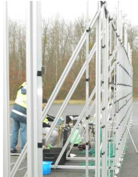
(c) Série de mesures de bruit au passage de véhicule, sur une piste d'essai [87].
