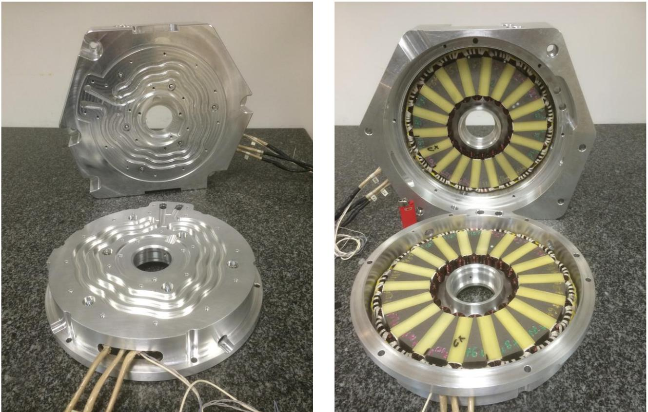
Figure III.41 : Circuit de refroidissement de la machine.
