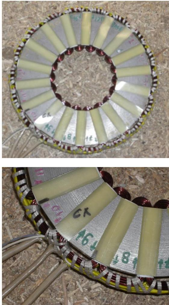
Figure III.37 : Réalisation du bobinage concentrique.
