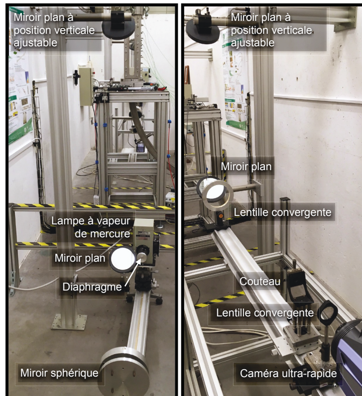
FIGURE 4.6 – Photographie du banc d'imagerie strioscopique (gauche : émission, droite : collection).
