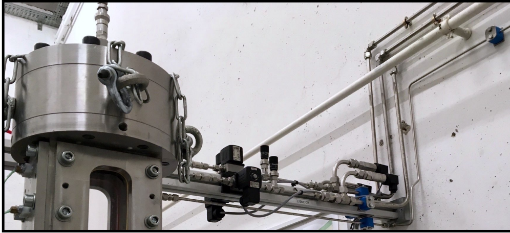
FIGURE 3.6 – Photographie d'une portion du circuit d'injection automatisée.
