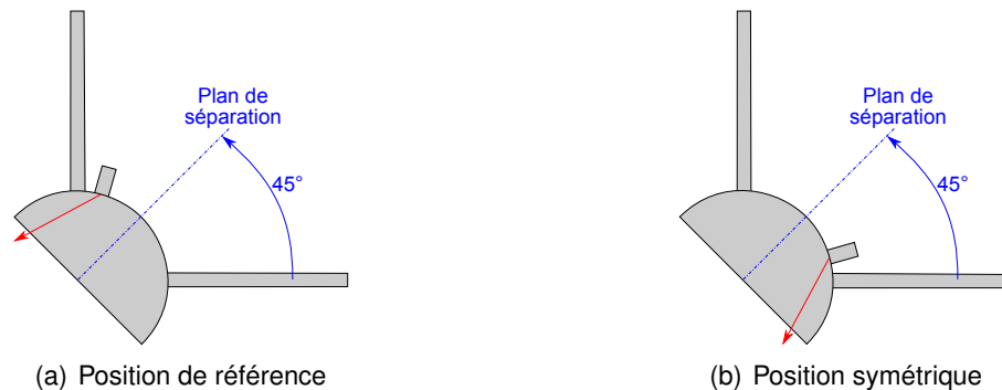
FIGURE 4.12 – Symétrie de l'effet du plot pour une position de part et d'autre du plan orienté de 45^\circ par rapport à l'horizontale
