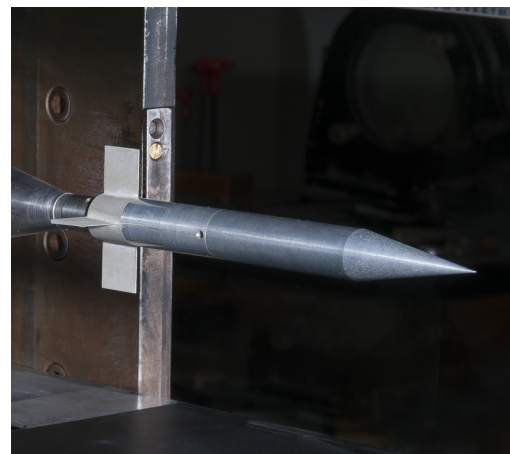
(b) Basic Finner monté dans la veine d'essai
