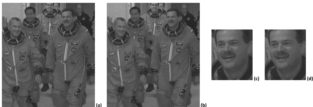
Figure 2.39. Image de la séquence Crew 4CIF encodée avec et sans prétraitement à QP 22 (correspondant à environ 8 Mbit/s) (a) Partie d'une image de la séquence Crew encodée sans préfiltre – (b) Partie d'une image de la séquence Crew encodée avec préfiltre à un débit 17,1% inférieur – (c) Agrandissement d'une image de la séquence Crew encodée sans préfiltre – (d) Agrandissement d'une image de la séquence Crew encodée avec préfiltre à un débit 17,1% inférieur
