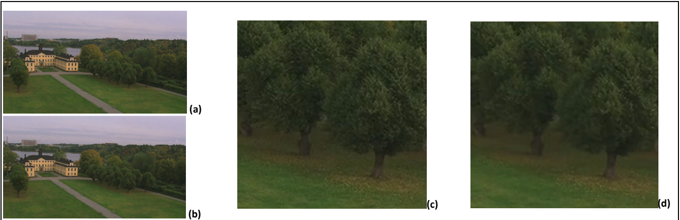
Figure 2.43. Comparaisons Visuelle d'une image de la séquence IntoTree 1280x720 50p encodée avec et sans préfiltre à QP22 en GOP IBBP12
