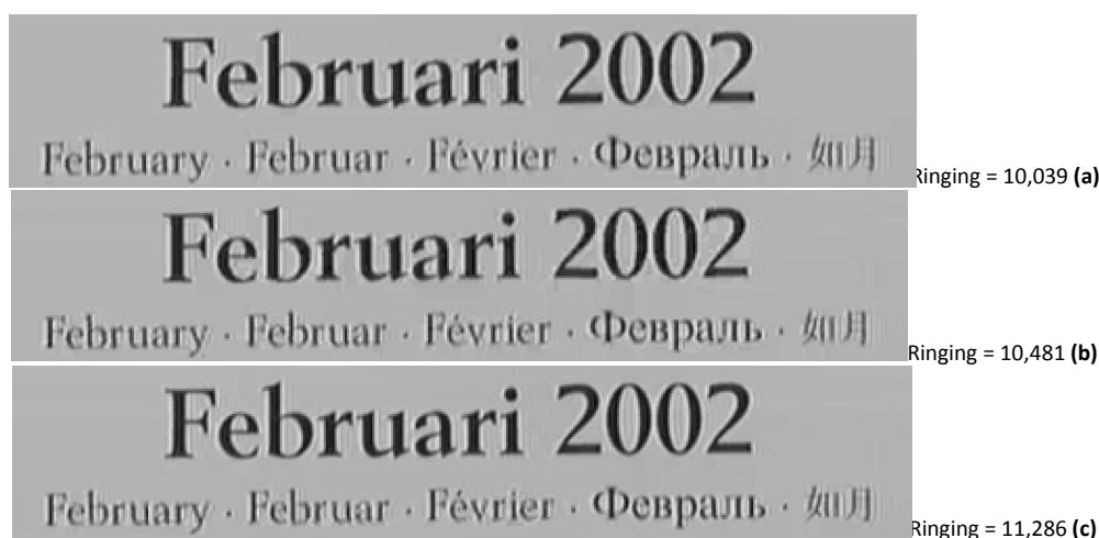
Figure 4.34. Comparaison de la quantification adaptative x264 et JND pour une image de la séquence Mobile & Calendar , 3Mbit/s, GOP IBBP12 (a) Zoom dans l'image encodée x264 – (b) Zoom dans l'image encodée x264 + AQ - (c) Zoom dans l'image encodée x264+AQJND
