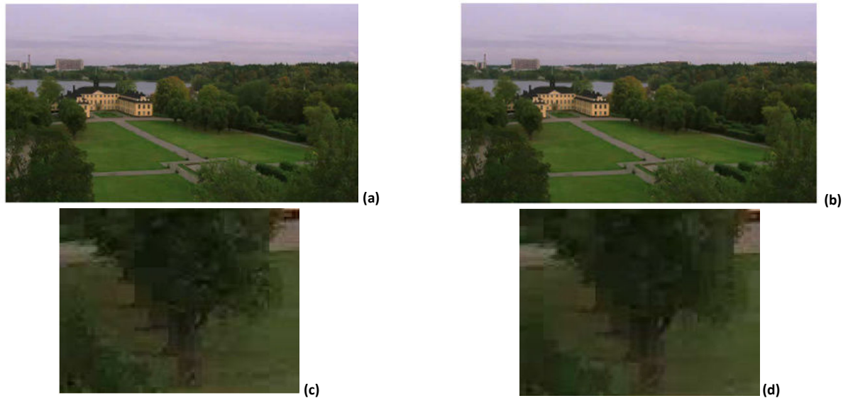
Figure 2.42. Image de la séquence IntoTree 1280x720 encodée avec et sans prétraitement à QP 32 (correspondant à environ 11 Mbit/s) (a) Partie d'une image de la séquence IntoTree encodée sans préfiltre – (b) Partie d'une image de la séquence IntoTree encodée avec préfiltre à un débit 6,2% inférieur – (c) Agrandissement d'une image de la séquence IntoTree encodée sans préfiltre – (d) Agrandissement d'une image de la séquence IntoTree encodée avec préfiltre à un débit 6,2% inférieur
