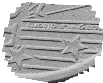
Figure III-26 - Reconstruction de la surface d'une pièce de 10 centimes d'euros recouverte préalablement avec une peinture blanche. La mesure a été réalisée sous un éclairage en lumière blanche
