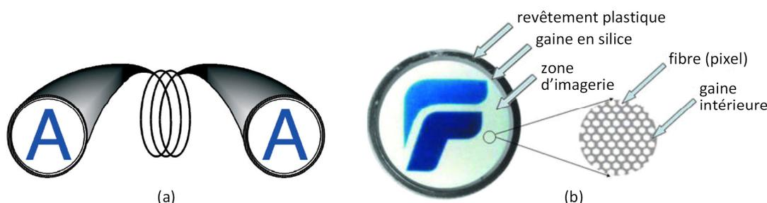
Figure III-16 - (a) Schéma d'un guide d'images fabriqué par la société Fujikura. (b) Schéma d'une interface du guide d'images.
