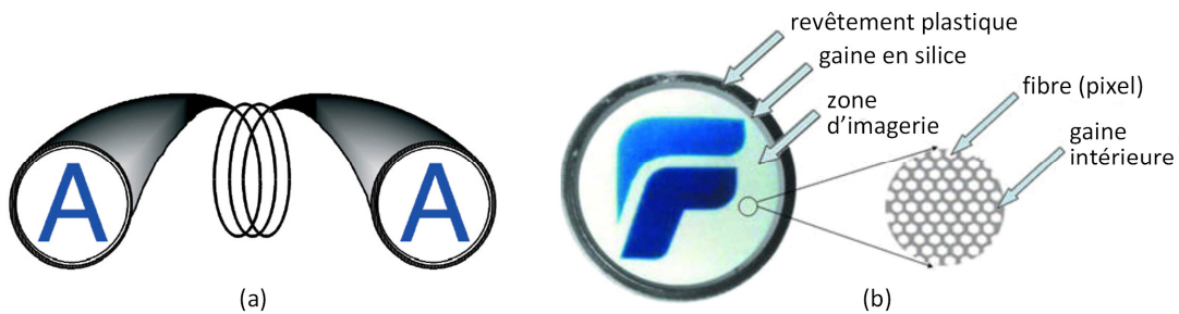
Figure III-16 - (a) Schéma d'un guide d'images fabriqué par la société Fujikura. (b) Schéma d'une interface du guide d'images.
