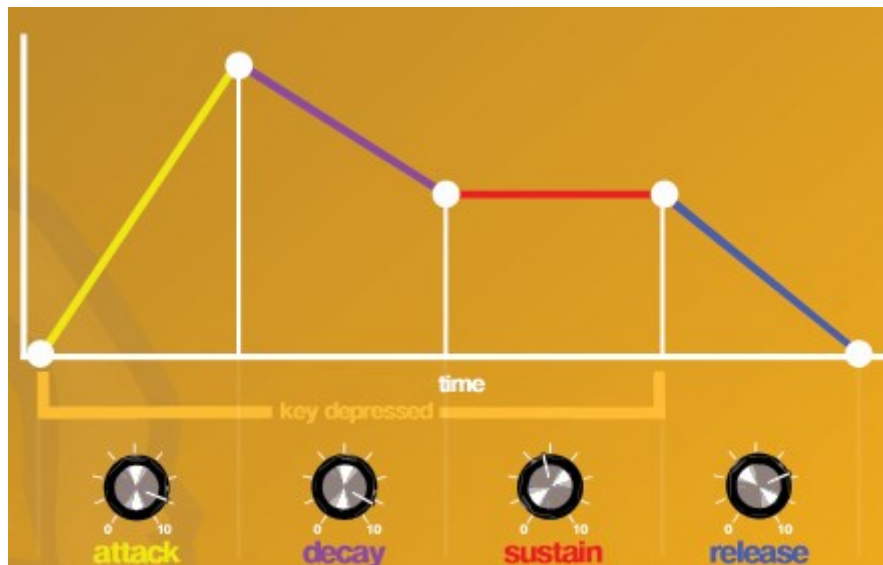
Figure 66 : le modèle habituel d'enveloppe "ADSR", attaque, déclin, maintien, relâchement. (source : http://moogfoundation.org )
