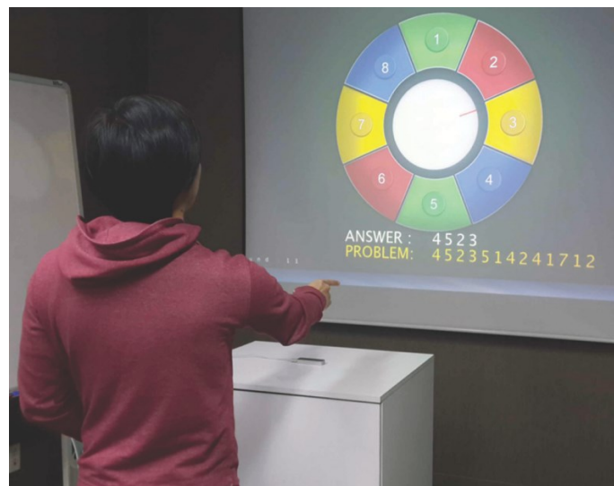
Figure 21 : vue d'un utilisateur en interaction avec le pie-menu. Le feedback sonore permet à l'utilisateur de se situer plus précisément dans le menu, que ce soit pour se déplacer ou pour effectuer une sélection
