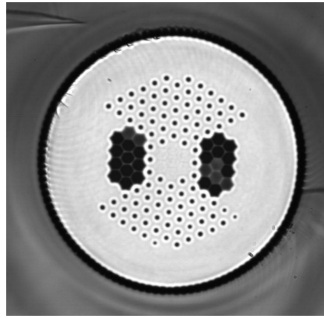
(a) Section de la fibre.
