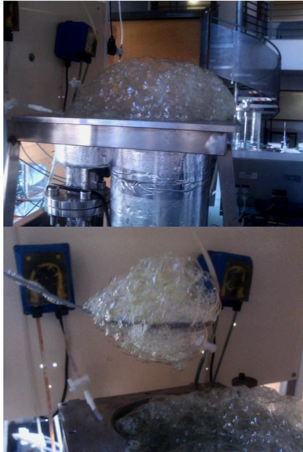
**Figure 25 : Photographies de la mousse que l'on rencontre lors de l'apparition de phénomènes de lyse cellulaire. La persistance de la mousse peut être observée, elle pose beaucoup de problèmes, notamment d'écoulement dans les tuyaux. Photos prises à l'occasion d'un nettoyage du réacteur (le faisceau de fibres a été retiré)**
