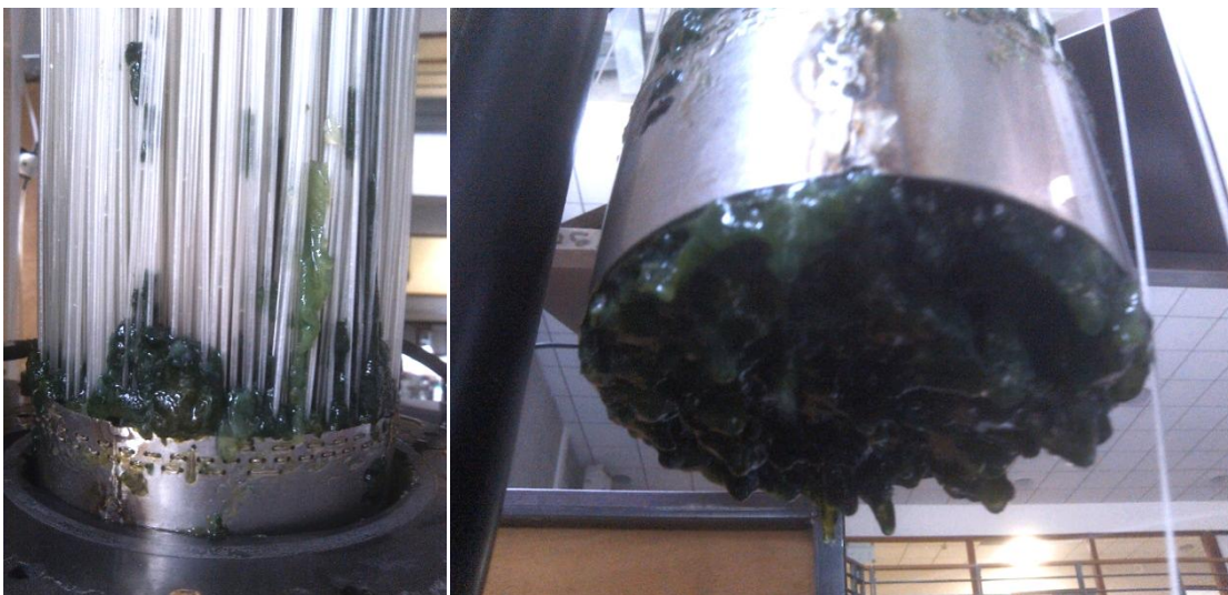
Figure 27 : Photographies des amas de polysaccharides qui se forment dans le faisceau de fibres optiques lors de cultures de Spiruline. Ces photos montrent principalement le bas du faisceau, là où se trouve le panier en inox qui maintient les fibres en position, cet endroit concentre l'essentiel des polysaccharides formés. La formation de ces amas reste présente mais a été nettement ralentie par l'ajout d'un bulleur central
