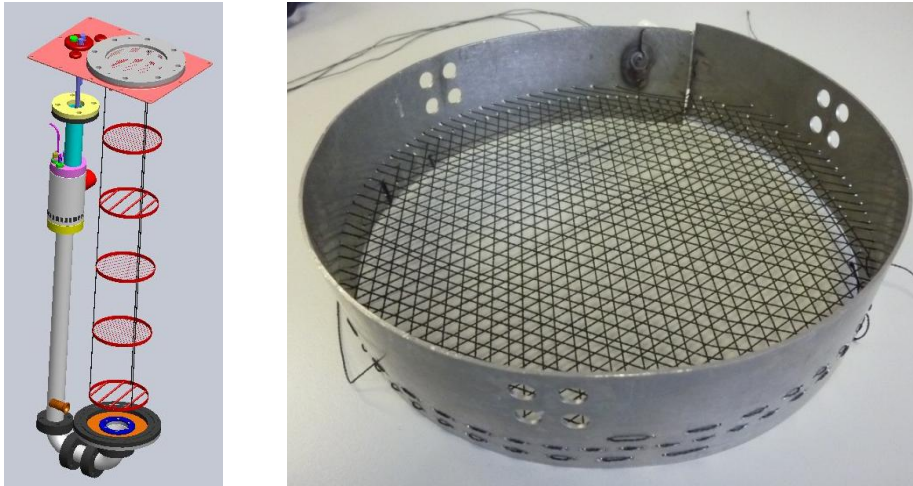
Figure 24 : Système de maintien des gaines tel qu'originellement conçu (à gauche) et panier modifié, utilisé lors de ces travaux (à droite). À l'origine (à gauche), cinq paniers répartis sur la hauteur du faisceau maintenaient les fibres en position, chaque panier ne portait qu'une seule nappe de câbles, orientés selon une seule direction. Le nombre de paniers a été réduit à un seul, positionné en bas des fibres. L'unique panier possède alors trois nappes de câbles, qui permettent de maintenir les fibres dans leur position de maille hexagonale.
