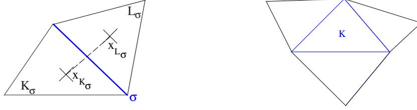
FIG. 1.8 – Gradient et divergence discrets : construction (à gauche) et support (à droite).
