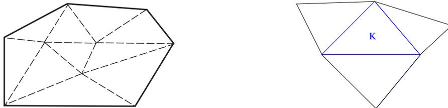
FIG. 1.1 – Maillage du domaine  $\Omega$  (à gauche) et l'ensemble  $\mathcal{V}(K)$  (à droite).
