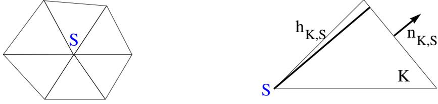
FIG. 3.1 – Représentation de  $\mathcal{N}(S)$  pour  $S \in \mathcal{V}_h^{int}$  ; définition de  $h_{K,S}$ ,  $\mathbf{n}_{K,S}$ .
