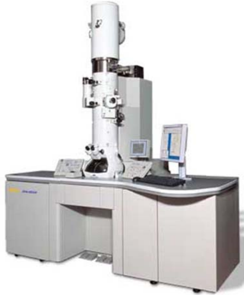
Figura 3.1 - Microscópio de transmissão eletrônica JEOL mod.JEM2010 ® .
