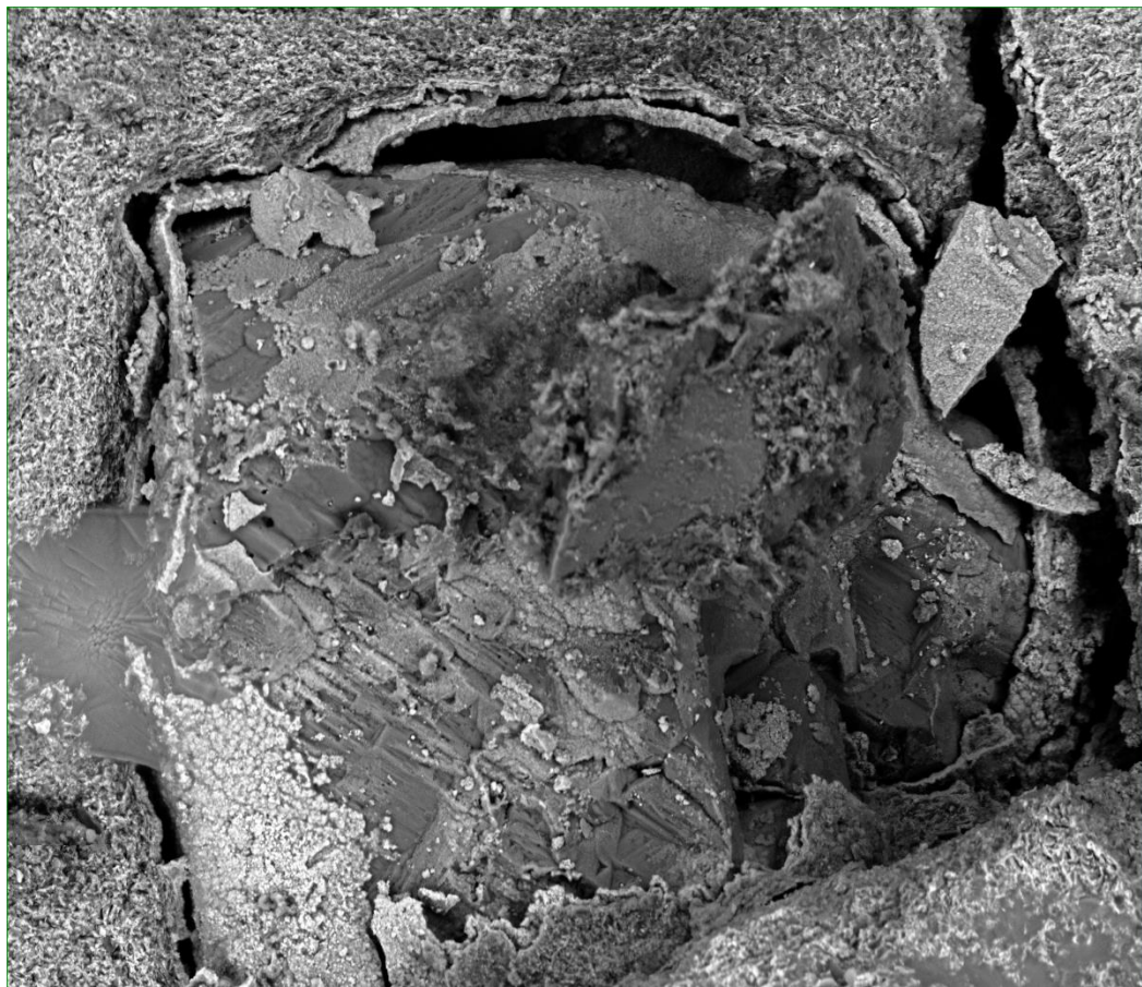
Figure 5-23: Cliché MEB correspondant au grossissement de la zone A sur le cliché de la Figure 5-21. Grains de quartz recouvert d'une fine pellicule composée de calcite, CSH, CAH, Ettringite...
