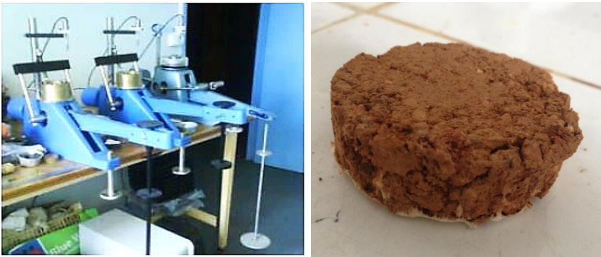
Figure 2-17 : Dispositif permettant de réaliser l'essai œdométrique et éprouvette de sol après test de compressibilité.
