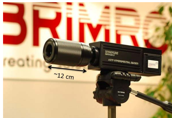
FIGURE 2.1: Brimrose, caméra hyperspectrale à AOTF dans le SWIR (900-1700 nm), 6 à 20 nm de résolution spectrale et 436 \mu rad de résolution spatiale (BRIMROSE, 2016).
