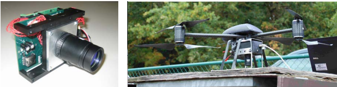
FIGURE 2.7: VTT, caméra hyperspectrale à filtre de Fabry-Perot pour drone léger.
