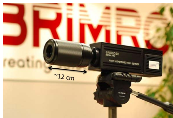
FIGURE 2.1: Brimrose, caméra hyperspectrale à AOTF dans le SWIR (900-1700 nm), 6 à 20 nm de résolution spectrale et 436 \mu\text{rad} de résolution spatiale (BRIMROSE, 2016).
