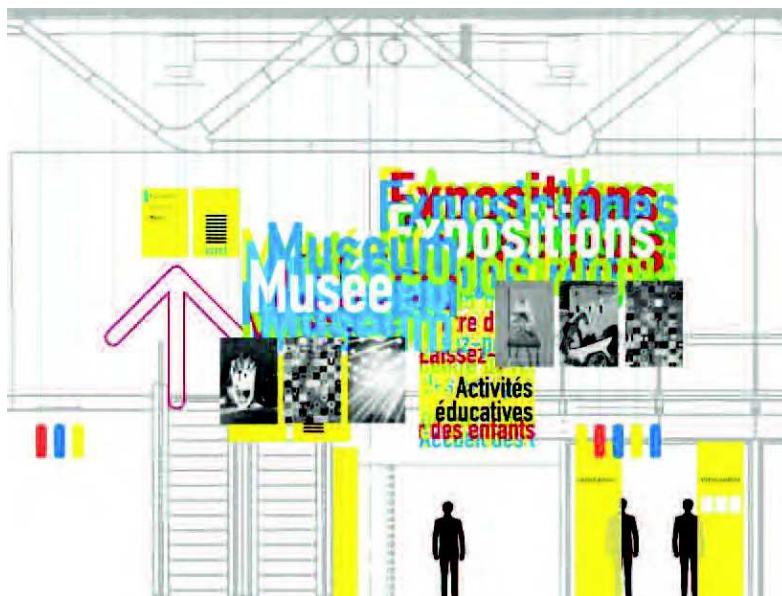
ill. 97. Les différents types de supports de signalétique et leur répartition dans l'espace. Les informations principales (information, billetteries, groupe, et les grandes destinations) se distinguent par leur traitement en plusieurs langues. Les informations temporaires sont imprimées sur papier en noir et blanc.
