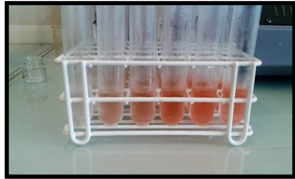
Figure 2. 15 Gamme d'étalonnage du fructose et zone de linéarité d'après la méthode de Yaphe et Arsenault (1965).
