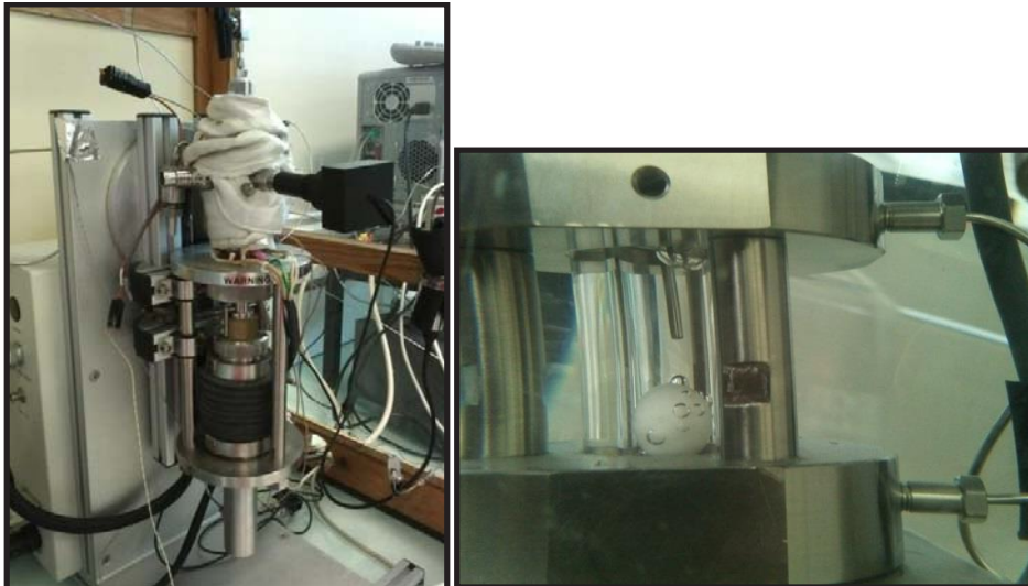
Figure 0-6: Photo de gauche: L'instrument de Thar Instruments ; à droite: cellule en saphir (CTP).
