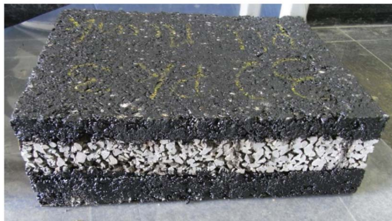
Figure 2.29: Prototype tricouche avec couche intermédiaire au liant en polyuréthane [89]
