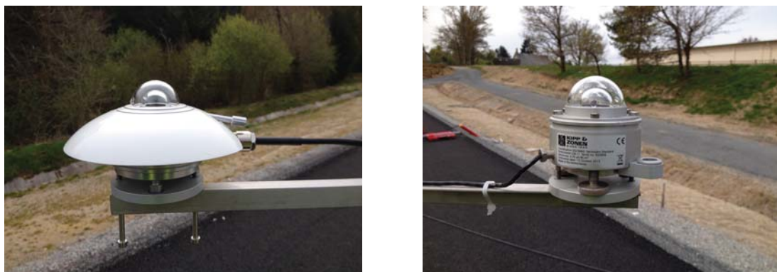
Figure 4.23: Pyranomètres pour la mesure du flux visible incident
