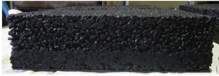
Figure 2.30: Prototype tricouche avec couche intermédiaire bitumineuse [89]
