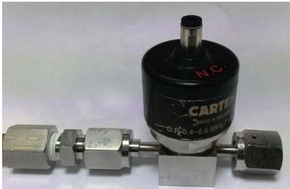
(a) Vanne entrée/sortie du réacteur
