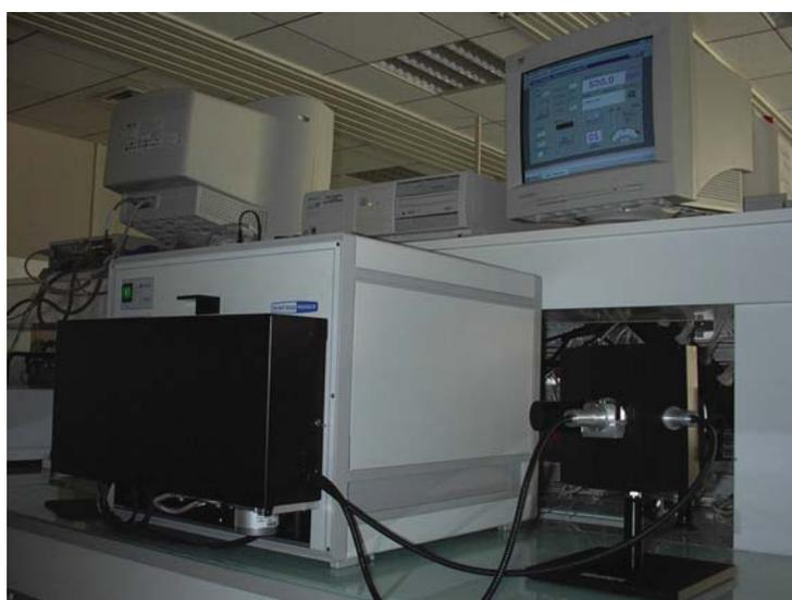
FIGURE 3.19 – Photographie du banc optique couplé à une sphère d'intégration de haute précision
