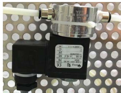
(b) Électrovanne commandant l'ouverture des vannes entrée/sortie
