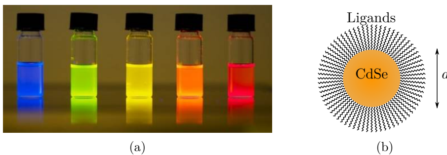
FIGURE I.3 – (a) Suspensions colloïdales de nanocristaux de CdSe de différentes tailles illuminées par une lampe à ultraviolets (© Nexdot) ; (b) schéma d'un nanocristal colloïdal de CdSe entouré de ses ligands assurant la stabilité colloïdale.
