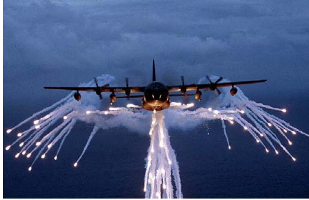
FIGURE I.7: Déploiement des leurres pyrotechniques d'un Lockheed MC-130
