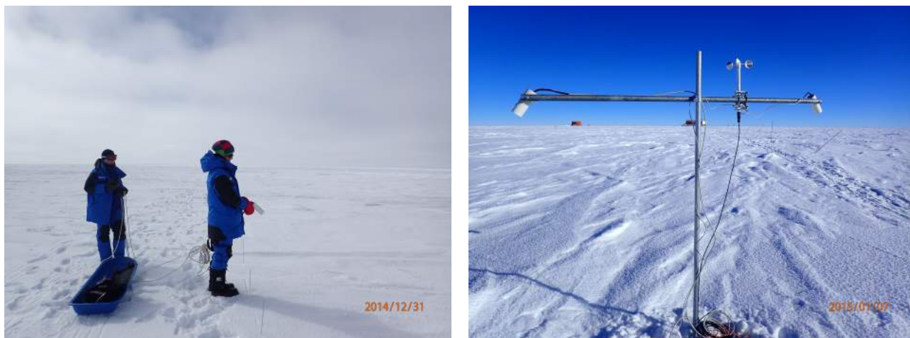
FIGURE 2.4 – (gauche) Mesure de la variabilité spatiale à petite échelle de la T_s à l'aide du capteur thermique IR120. (droite) Mesure de la vitesse du vent par un anémomètre et du cycle diurne de la T_s en deux points par deux capteurs thermiques IR120.
