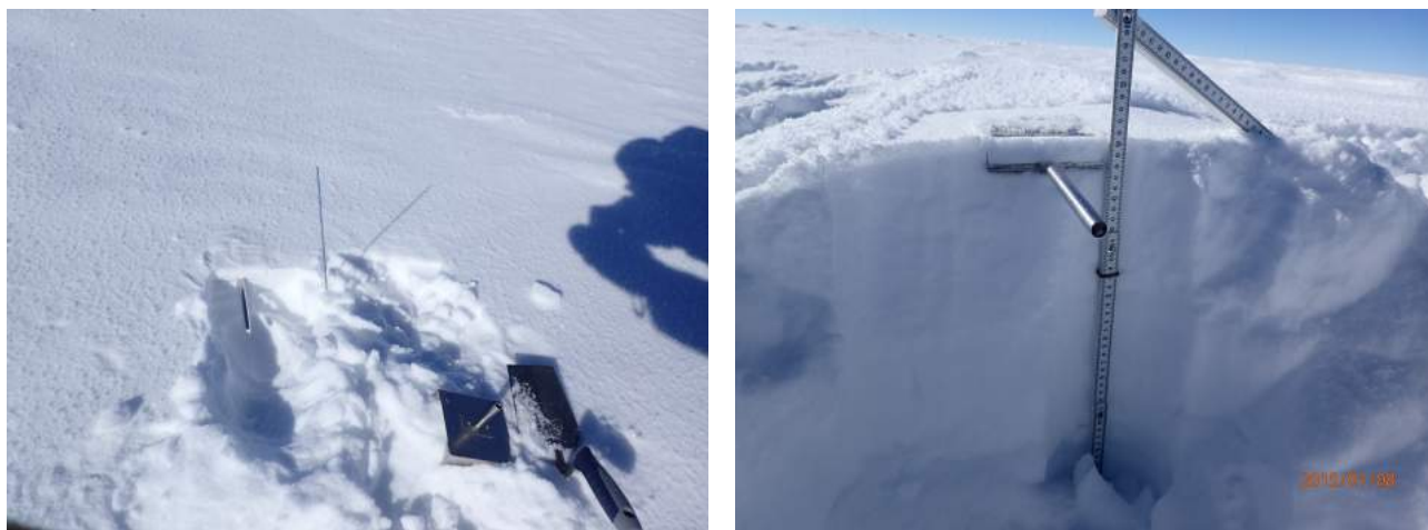
FIGURE 2.5 – Mesure de la densité à Dôme C durant ma campagne de mesure 2014-2015 : (gauche) mesure de la densité d'échantillons de neige prélevés en surface ; (droite) mesure d'un profil de densité.
