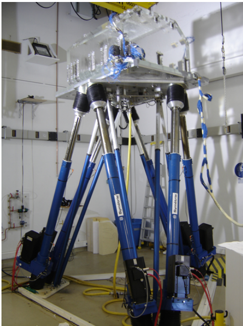
FIGURE 0.3 – Modèle de cuve à l’échelle 1/40 (environ 1\text{ m}^3 ) sur un hexapode simulant les mouvements du navire. Des capteurs mesurent les pressions maximales à la paroi lors des impacts de liquide.
