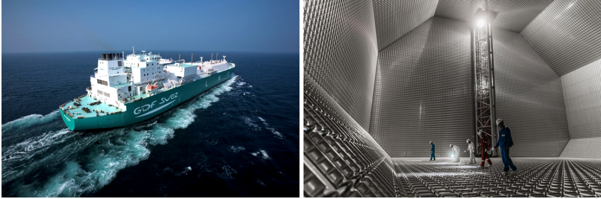
FIGURE 0.2 – À gauche : méthanier. À droite : inspection d’une cuve équipée de la technologie Mark III développée par GTT. Les corrugations permettent à la membrane métallique en inox de se déformer légèrement avec la dilatation thermique.
