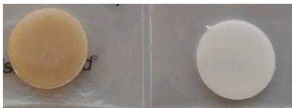
Figure 99 : Photos de pastilles du mélange d'étude PS/PA6-1 80/20 obtenues par thermocompression (à gauche) et par mini presse à injecter (à droite)
