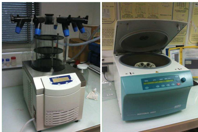
Figure 50 : Lyophilisateur (à gauche) et centrifugeuse (à droite) utilisés pour sécher et purifier les colloïdes hybrides synthétisés
