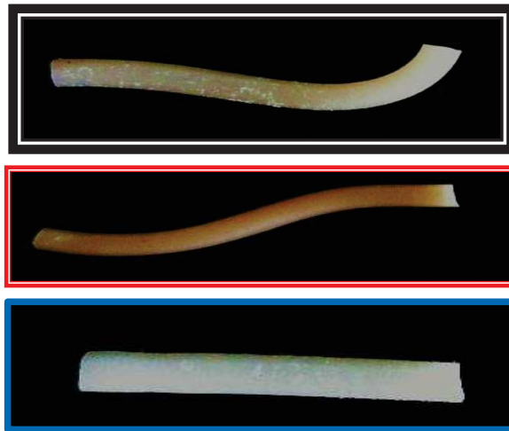
Figure 105 : Photos des joncs obtenus à la sortie du microcompounder de haut en bas, PS/PA6-1 80/20, PS/PA6-1/SiNPs vierges 80/20/3 et PS/PA6-1/SiNPs modifiées 80/20/3
