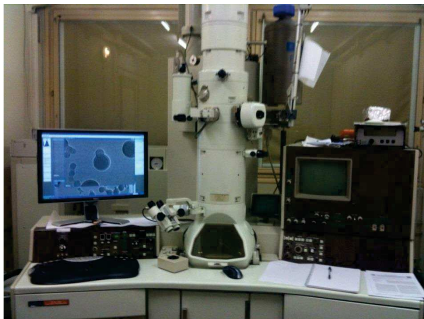
Figure 65 : Microscope électronique à transmission équipé d'une sonde EDX haute résolution
