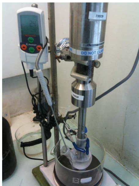
Figure 49 : Montage utilisé pour la sonification du mélange réactionnel afin d'obtenir une miniémulsion
