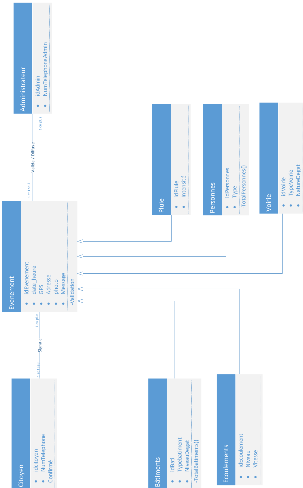
Source : Kouadio (2016) Figure 5.19 : Diagramme de classe.
