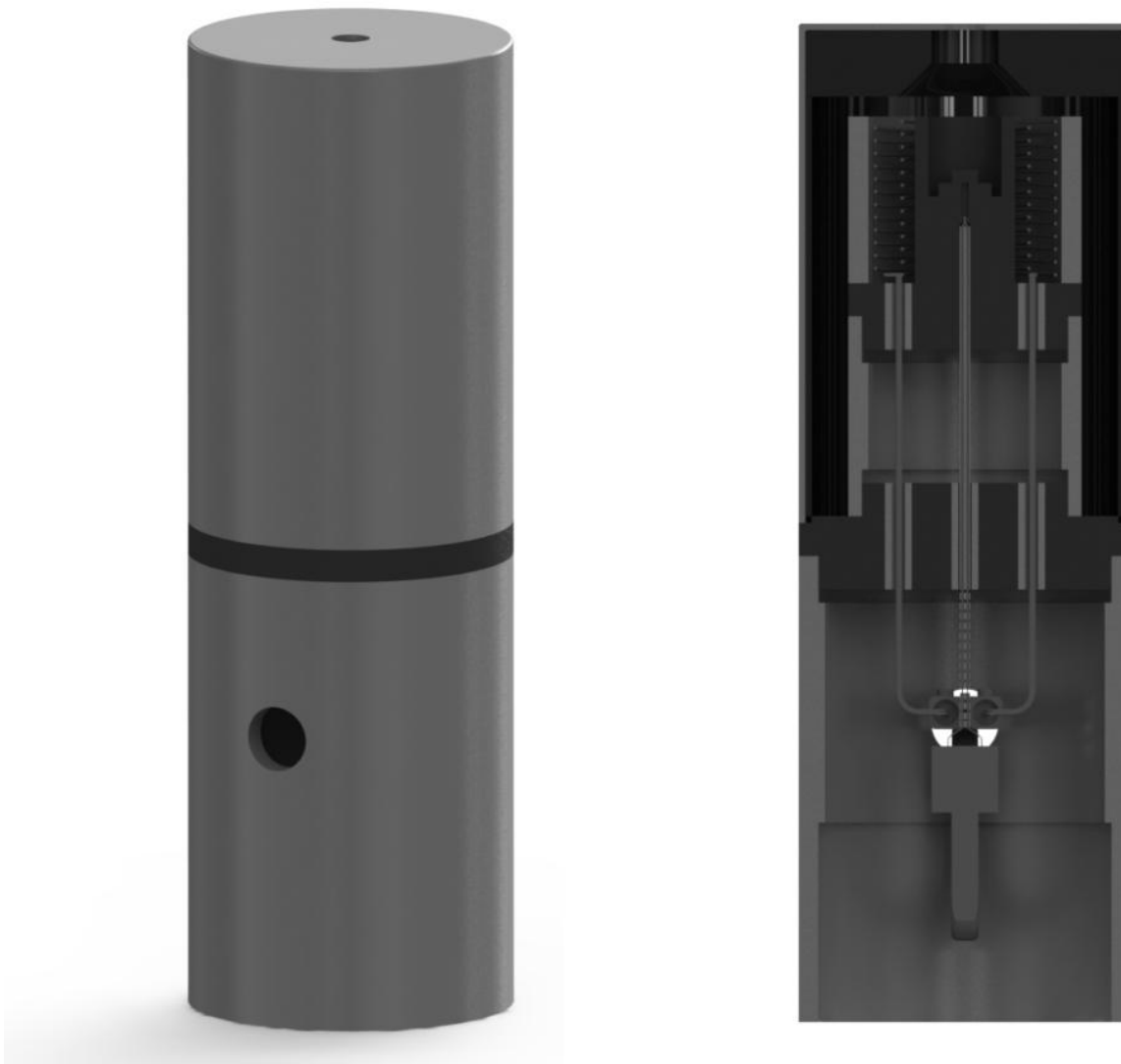
FIGURE C.5 – À gauche, une vue en perspective du four. À droite, une vue en coupe du four.
