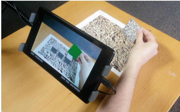
FIGURE 4.7 — Plateforme expérimentale pour l'étude de la technique de découplage. La tâche représentée ici est celle de la première expérience (tri d'objets).
