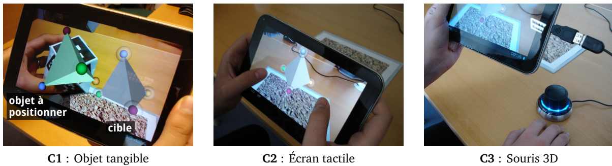
FIGURE 3.10 — Illustration des trois conditions de cette expérience. La condition C1 représente notre concept d'interface tangible et mobile. La condition C2 consiste à utiliser l'écran tactile pour manipuler l'objet 3D. La condition C3 consiste à utiliser une souris 3D pour contrôler l'objet manipulé.
