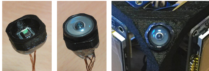
FIGURE 6.11 — Capteurs utilisés pour le suivi dans notre démonstrateur. Nous rajoutons sur chaque capteur une lentille grand-angle pour élargir son champ de vision. Les capteurs ainsi assemblés sont ensuite placés sur chaque sommet de la structure.
