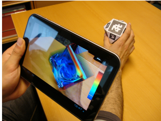
FIGURE 3.5 — Visualisation et manipulation sur 6 DdL du volume de données dans notre interface. L'utilisateur manipule la donnée virtuelle à travers l'objet de référence et observe le résultat à travers la tablette, comme si la donnée était réellement dans sa main.
