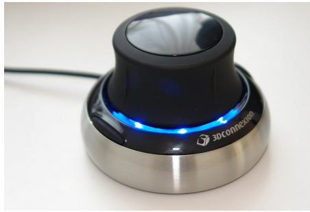
FIGURE 3.9 — Le SpaceNavigator, un modèle de souris 3D utilisé dans cette expérience.
