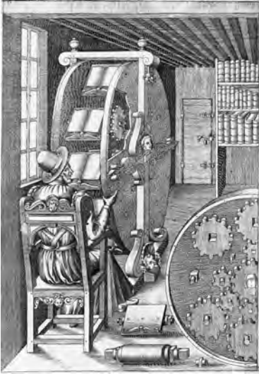
↑ Roue aux livres Agostino Ramelli Figure CLXXXVIII In Le diverse et artificieuse machine del Capitano Agostino Ramelli , 1588
