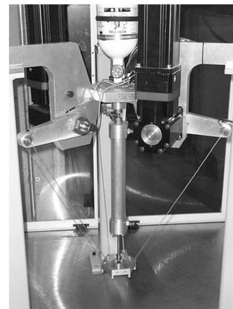
(b) The DeltaBot<sup>TM</sup> prototype [Dekker et al. 2006].
