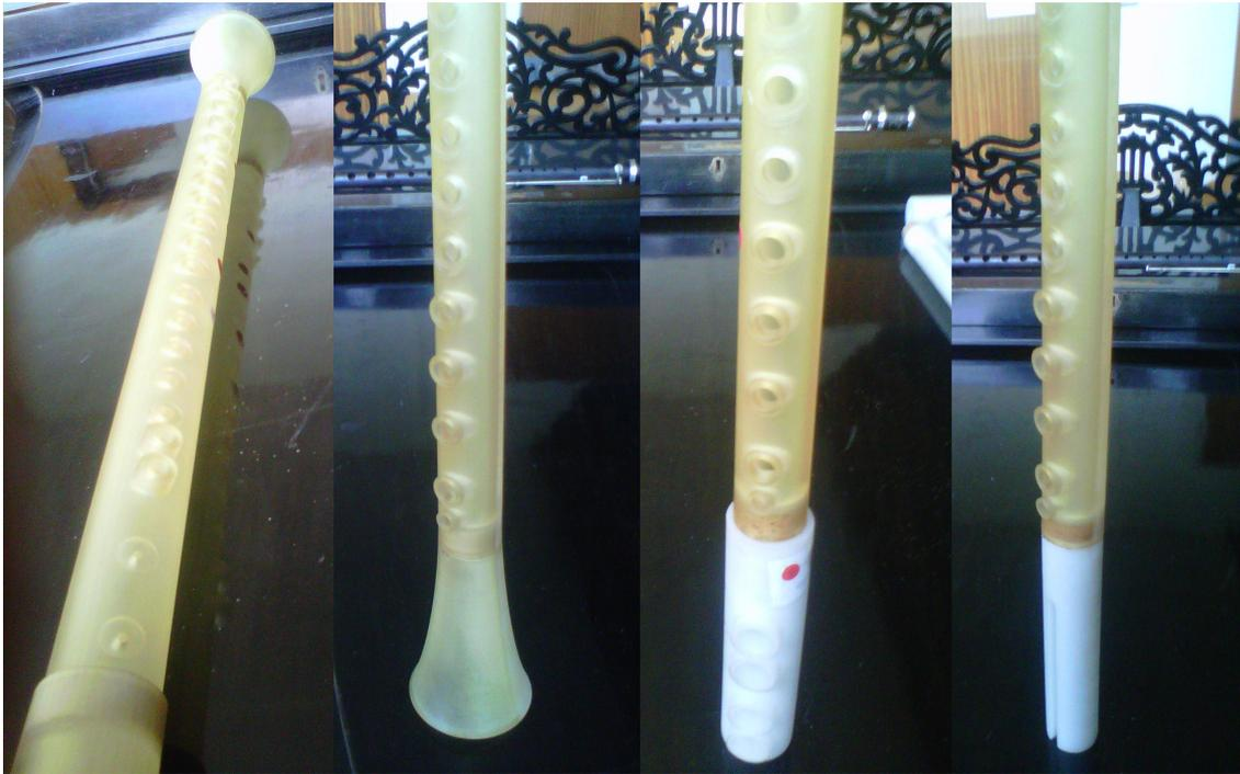
**FIGURE 5.19:** *Troisième prototype réalisé par un procédé de prototypage rapide. A gauche, le prototype est associé au pavillon évasé. Les deux photos de droite correspondent aux pavillons à trous (14 cm) et à fente longitudinale.*
