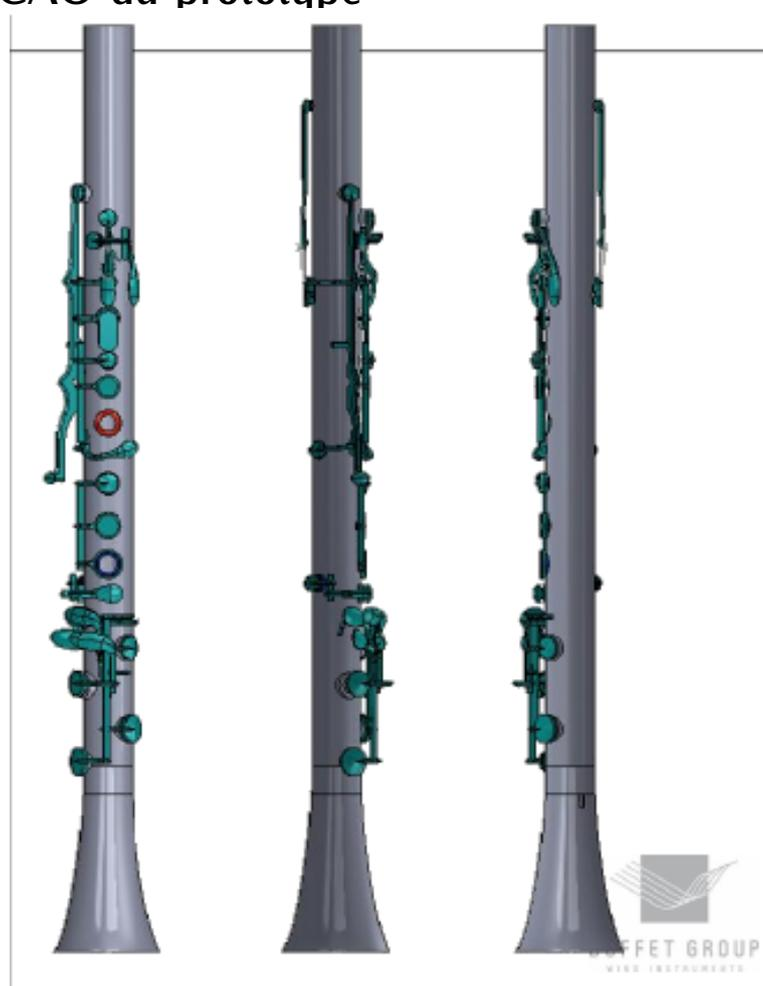
**FIGURE D.4:** Exemple de plan de réalisation du clétage Boehm simplifié appliqué à une géométrie issue de l'optimisation. A noter que le plan, ici n'est pas complet car il manque encore les leviers du petit doigt de la main gauche.
