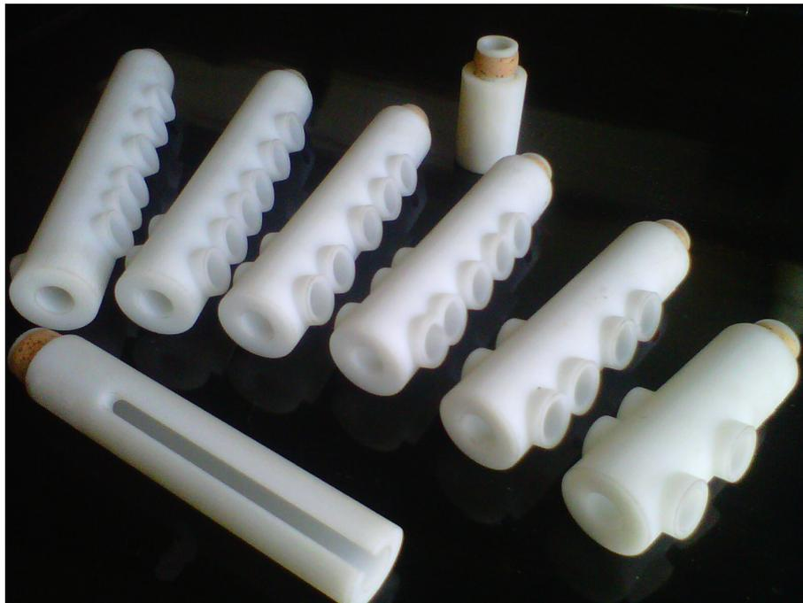
**FIGURE 5.11:** Réalisation des 6 pavillons à trous latéraux de 20 à 10 cm (de gauche à droite). En bas, le pavillon à fente longitudinale et en haut un pavillon cylindrique permettant simplement d'ajuster la fréquence de résonance de la première note de chaque registre.
