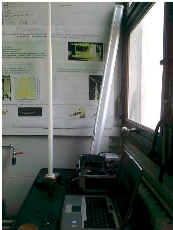
**FIGURE B.1:** *Dispositif expérimental de mesure d'impédance d'entrée d'un tube ouvert. L'étanchéité de la connexion entre le tube et le capteur d'impédance se fait par l'intermédiaire d'une pièce adaptatrice et d'un joint torique.*
