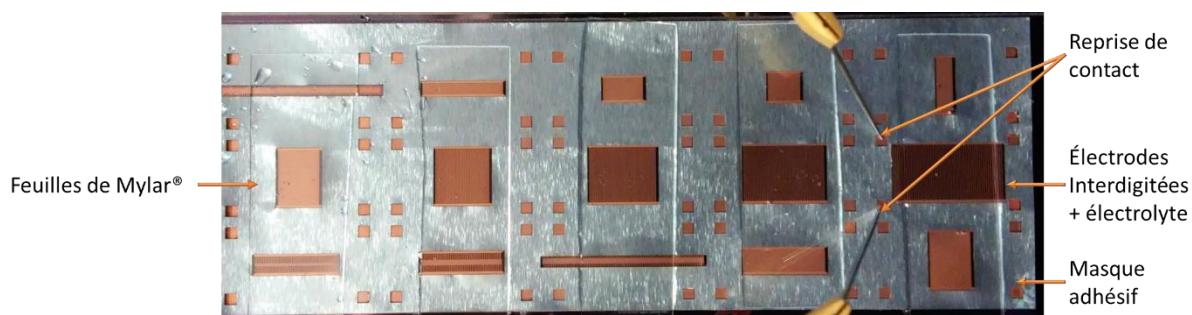
Figure II- 14 : Image d'un module de cellules interdigitées recouvertes d'un masque adhésif.
