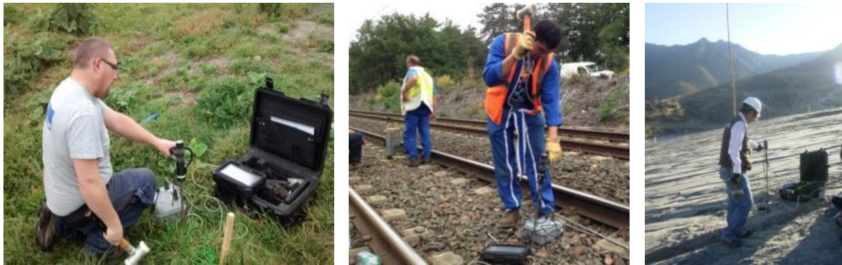
Figure 7-1. Campagnes expérimentales réalisées avec le pénétromètre PANDA 3 – faisabilité de l'essai au contraintes imposées par le terrain : (a) site expérimental de Gerzat, (b) site ferroviaire de Vierzon et (c) barrage de résidus miniers au Chili.
