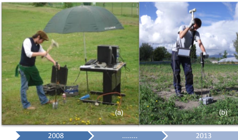
Figure 5-1. Réalisation d'un essai PANDA 3 – Evolution du matériel vers un prototype industriel : (a) maquette expérimentale et (b) prototype PANDA 3. 4.
