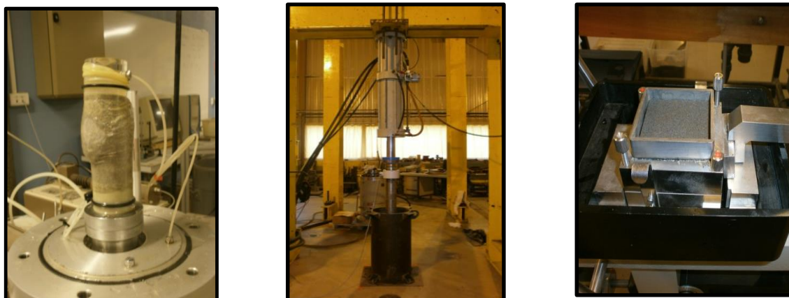
Figure 11-4. Réalisation des essais complémentaires : (a) essai triaxial, (b) essai de chargement de type œdométrique et (c) essai de cisaillement à la boîte (Llanca-Vargas 2014).
