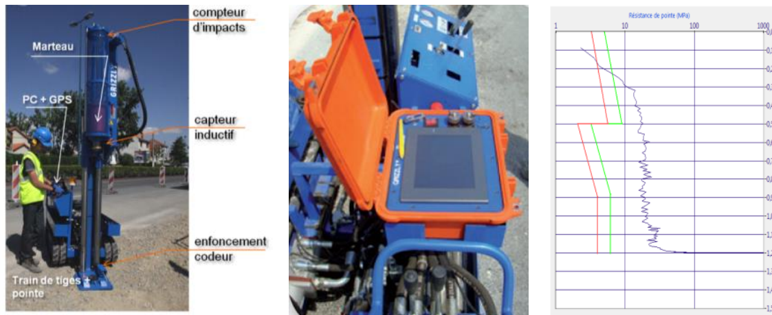
Figure 2-8. (a) Le pénétromètre GRIZZLY, (b) ordinateur de bord et (c) le logiciel GRIZZLY permettant d'obtenir le pénétrogramme et les courbes de référence (Benz-Navarrete et al. 2012).
