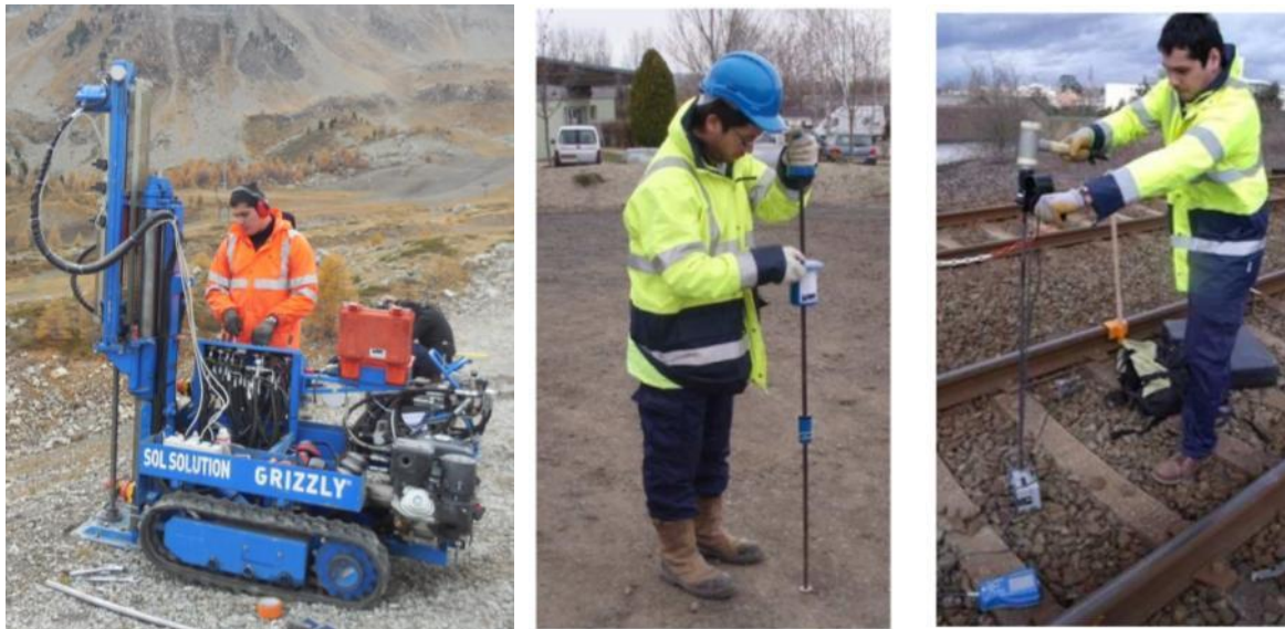
Figure 2-6. Types de pénétromètres dynamiques développés par Sol Solution : (a) pénétromètre lourd GRIZZLY, (b) le pénétromètre du type DCP PANDITO et (c) pénétromètre à énergie variable PANDA 2.
