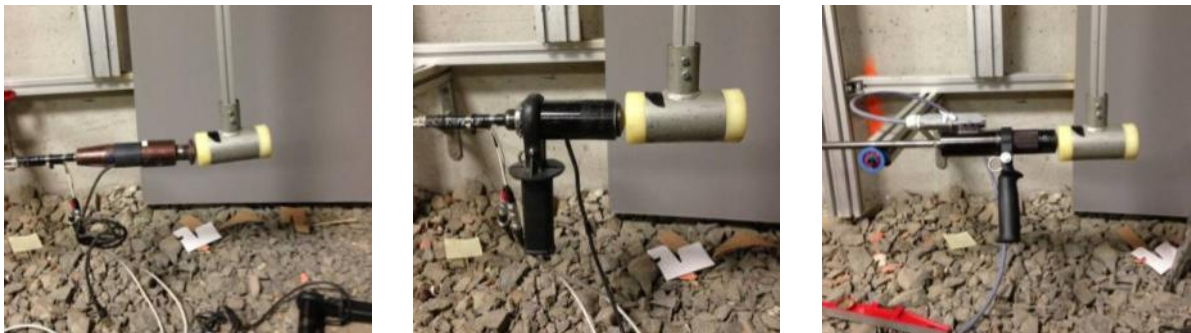
Figure 5-15. Mesures réalisées au pendule : (a) tête de battage PANDA 1, (b) tête de battage PANDA 2 et (c) tête de battage PANDA 3.
