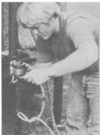
Figure 2-7. Instrumentation du SPT : (a) vissage de la cellule de charge dynamique dans le train de tige, (b) Mesure du passage des ondes lors du battage pénétrométrique (Tiedemann 1978).
