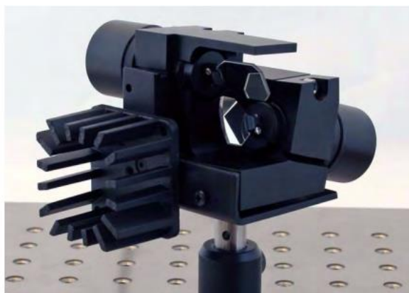
figure 2-8 : Photographie de la tête galvanométrique GVS112(/M) Thorlabs utilisée dans cette étude.
