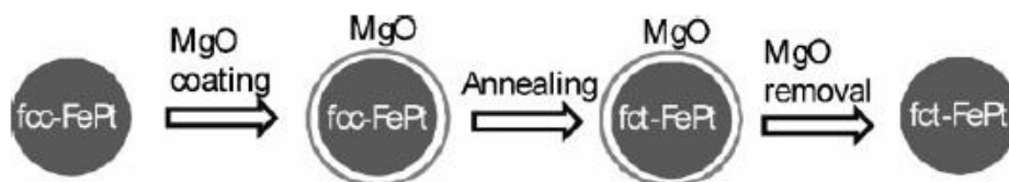
Figure 1.22. Schéma des différentes étapes pour l'obtention de NPs de FePt L 10 grâce à l'encapsulation individuelle par une coquille de MgO [Kim 2009].
