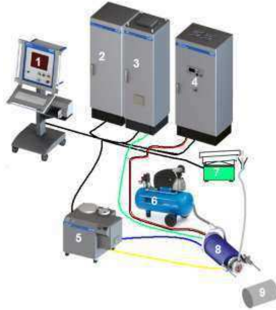
Figure 23. Schéma du système de projection plasma MultiCoat® de Sulzer Metco utilisé pour l'élaboration des dépôts.
