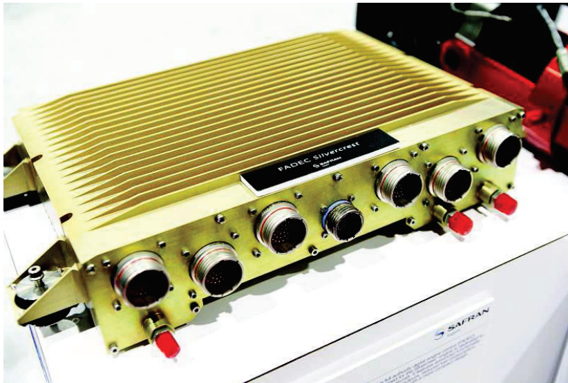
FIGURE 2.1: Calculateur de régulation numérique développé pour l'aviation d'affaires [21, 22].
