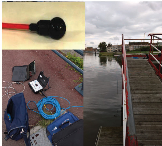
En haut : transducteur Emetteur positionné En bas : Valise émettrice dans l'eau
