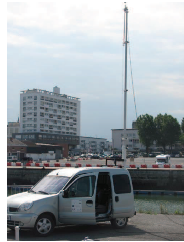
(b) Véhicule instrumenté avec mât télescopique.
