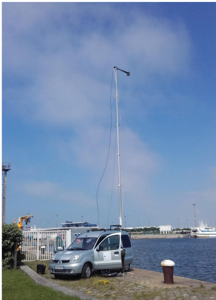
(a) Véhicule instrumenté avec mât télescopique.
