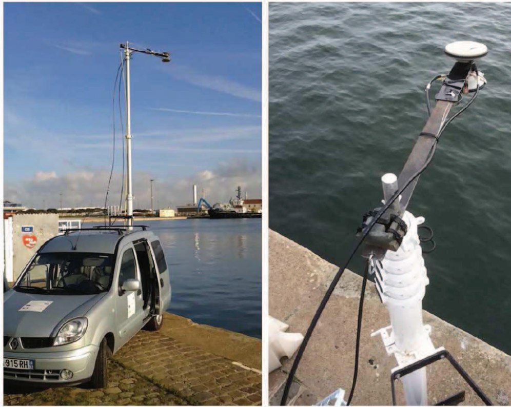
FIGURE 5.2 – Véhicule expérimental avec le mât télescopique, pouvant monter de 2 à 10 mètres, ainsi que le couple d'antennes réceptrices pour les signaux directs et réfléchis.
