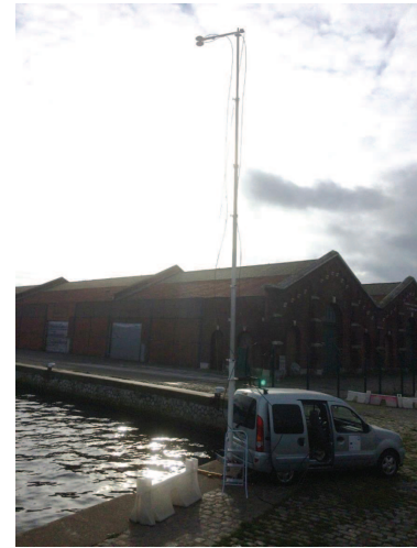
(b) Véhicule instrumenté avec mât télescopique.
