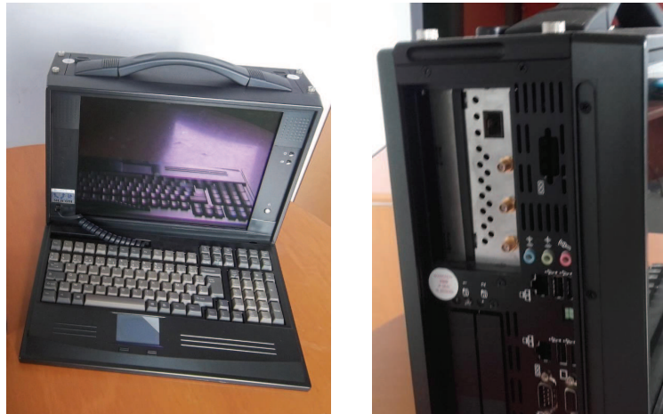
FIGURE 5.3 – Numériseur Silicom (3 voie d'enregistrement).
