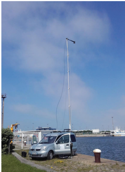
(a) Véhicule instrumenté avec mât télescopique.
