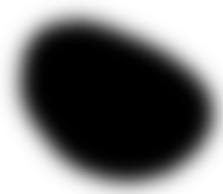
FIGURE 6.13 – Application d'un flou afin d'adoucir l'interface entre le butane et l'eau. Le blanc représente l'eau et le noir le butane. Cette étape contribue à la stabilité numérique, car elle fournit une interface diffuse comme donnée d'initialisation.
