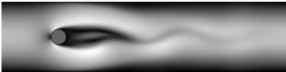
FIGURE 1.8 – Formation de la traînée en aval d’un obstacle circulaire - Visualisation du champ des normes de vitesses - MRT - t=12000 - Re=200 .
