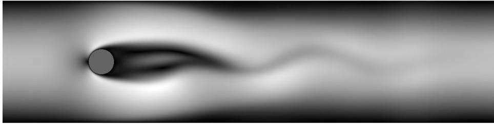
FIGURE 1.7 – Formation de la traînée en aval d’un obstacle circulaire - Visualisation du champ des normes de vitesses - SRT -  $t=12000$  -  $Re=200$ .
