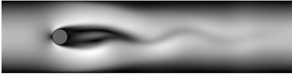
FIGURE 1.7 – Formation de la traînée en aval d’un obstacle circulaire - Visualisation du champ des normes de vitesses - SRT - t=12000 - Re=200 .
