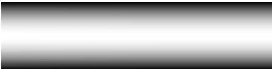
FIGURE 1.3 – Norme de vitesse le long d'une canalisation en régime laminaire - Re = 100 .
