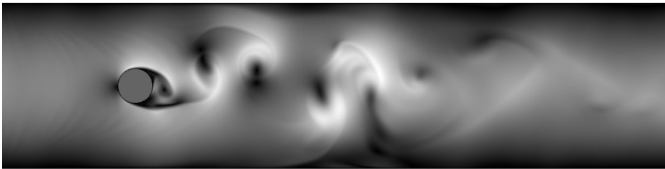
FIGURE 1.11 – Formation de la traînée en aval d'un obstacle circulaire - Visualisation du champ des normes de vitesses - paramètre de relaxation lié à la viscosité volumique : s_1 = 1,8 - MRT - t=12000 - Re=2000
