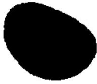
FIGURE 6.12 – Retrait des parasites et remplissage de l'intérieur de la goutte détectée par l'algorithme de détection de contour. Le blanc représente l'eau et le noir le butane.
