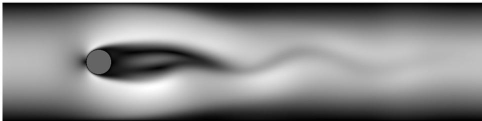
FIGURE 1.8 – Formation de la traînée en aval d’un obstacle circulaire - Visualisation du champ des normes de vitesses - MRT -  $t=12000$  -  $Re=200$ .
