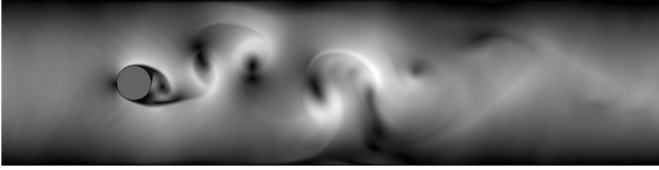
FIGURE 1.12 – Formation de la traînée en aval d’un obstacle circulaire - Visualisation du champ des normes de vitesses. SRT - t=12000 - Re=2000
