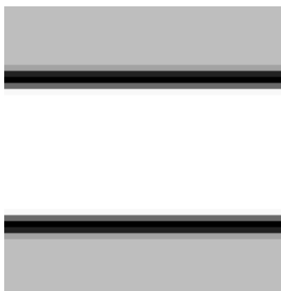
FIGURE 3.16 – Vue de la disposition des composants 1 (blanc) et 2 (gris) sur le domaine de calcul. L'interface entre les deux composants est visible en noir.
